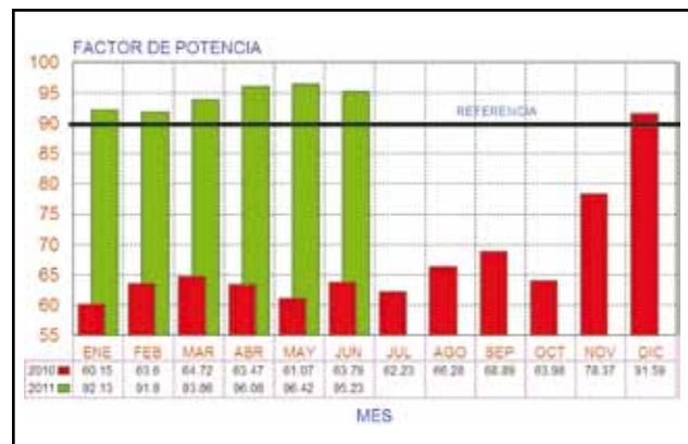
Fig. 3 Comportamiento real del valor del factor de potencia
