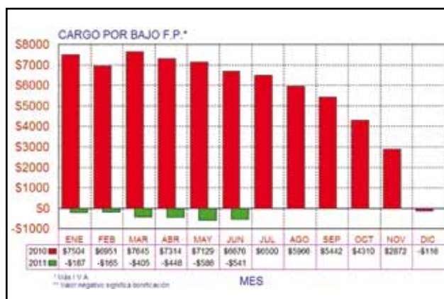
Fig. 4 Comportamiento real de penalizaciones y bonificaciones debido al factor de potencia
