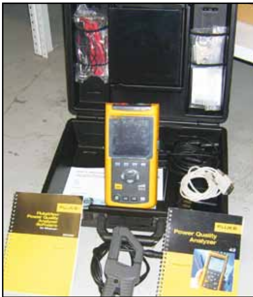
Fig. 2 Fotografía del analizador de la calidad Fluke™ 43
